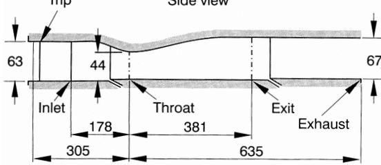
Fig. 1 Sajben *et al.* diffuser model.
